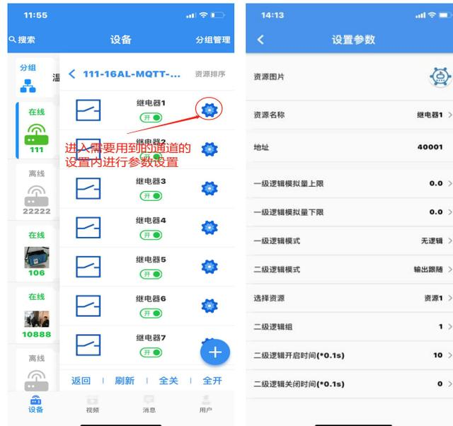
继电器参数设置界面中，可以对继电器名称、资源图片、模式、开启时间、关闭时间、报警模式等进行设置。
