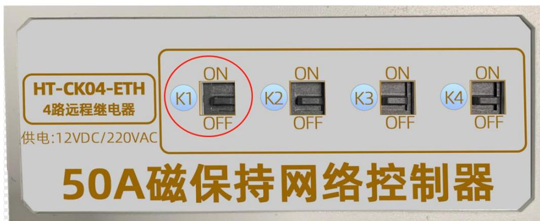
控制器的每一路输出通道，都可以通过继电器上方的机械开关，手动开、关继电器，以方便在断网或者断电的时候做应急处理。
