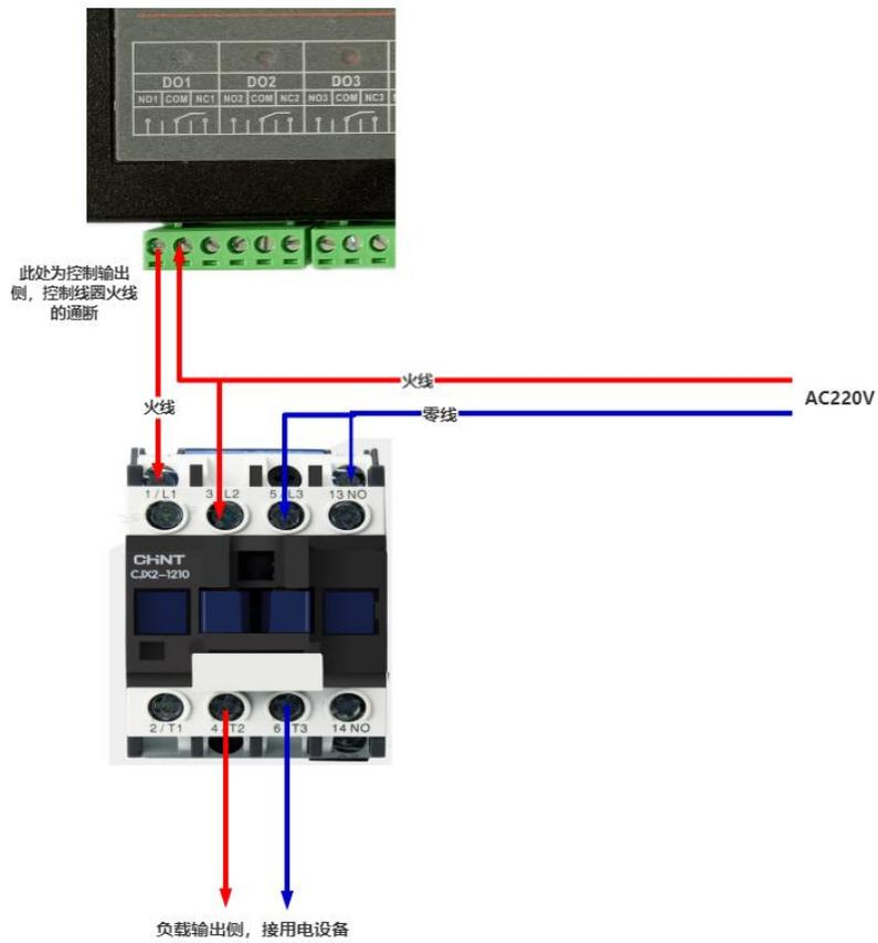
下图为用第一路通道控制 220V 线圈的交流接触器并带 380V 负载：
